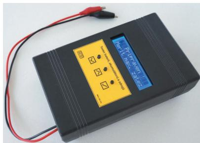
Druhou funkcí přístroje je měření náboje (kapacity) baterií. Zde se používá klasické měření vybíjením baterie zvoleným proudem po dobu než napětí baterie poklesne pod zvolenou mez.
